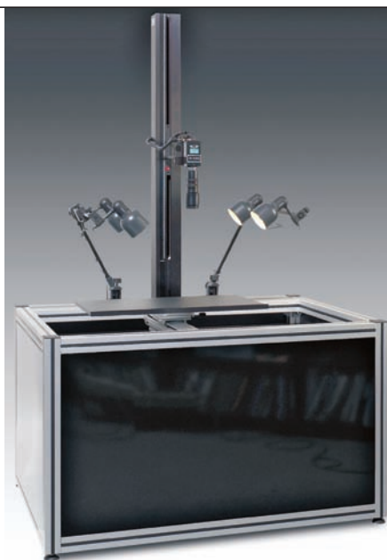
Sistema Robotizzato per l'ispezione automatica di artwork e materiale stampato
